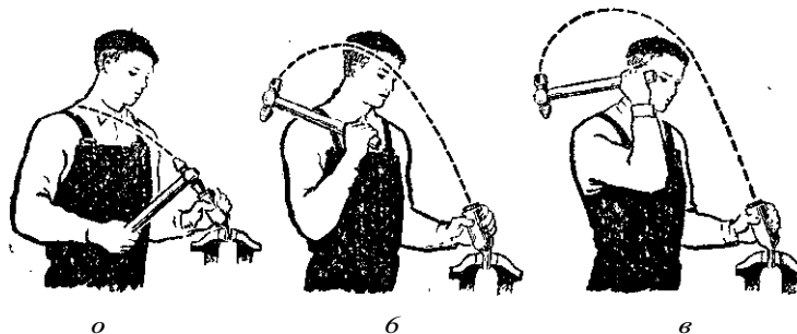
Рис. 67. Удари молотком: а — кистьовий; б — ліктювий; в — плечовий
