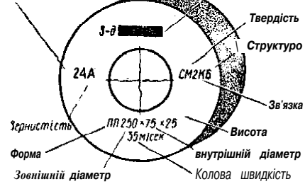
Рис. 176. Маркірування шліфувального круга
