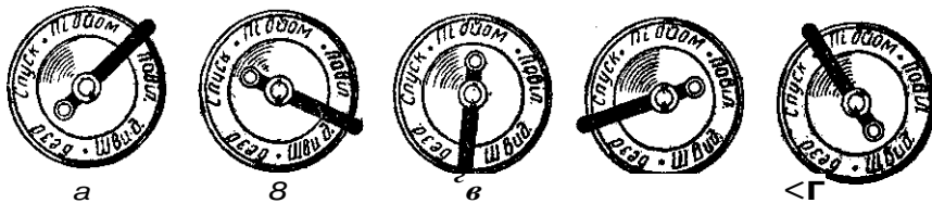
Рис. 130. Положення рукоятки при керуванні гідроприводом ножівкової пилі: а — «Бездіяльність»; б — «Спуск»; в — «Підйом»; г — «Повільна дія»; д — «Швидка дія»
