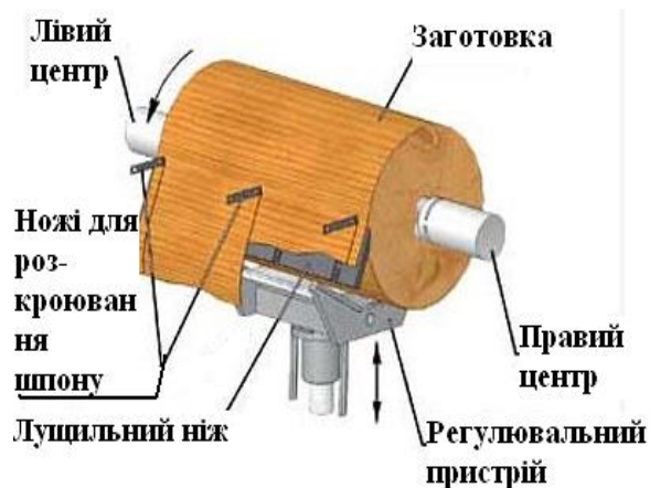
Рис.11.1. Схема верстата для виробництва луценого шпону.
