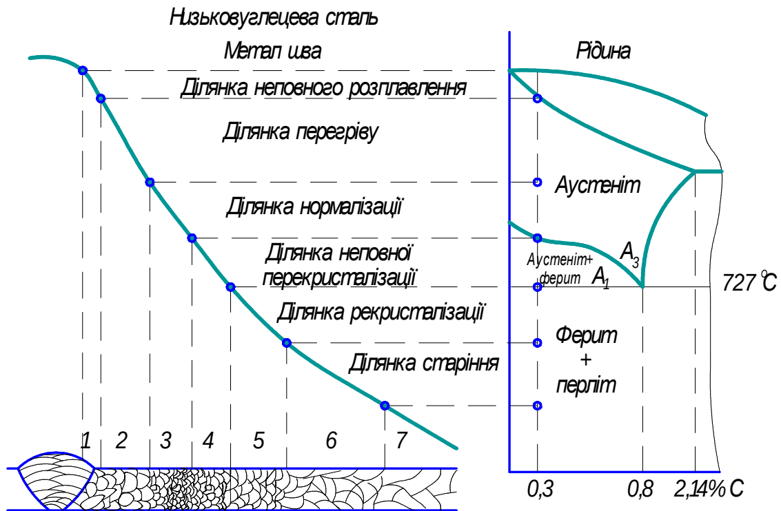
Рис.15 – Діаграма «Fe-C» зони термічного впливу:
