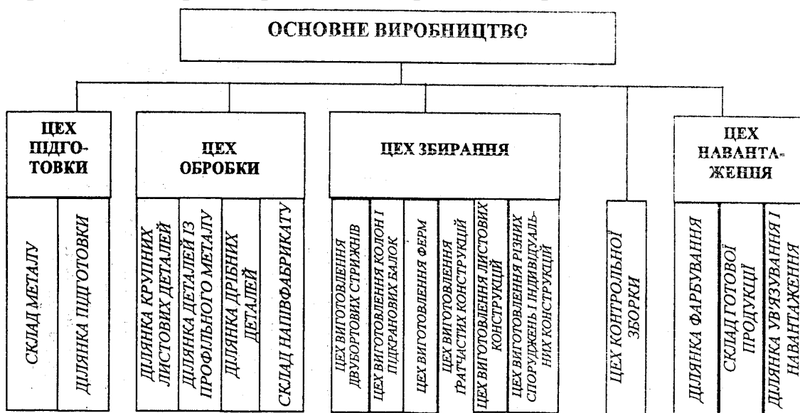
РИС. 3.1– Структура основного виробництва заводу металоконструкцій
