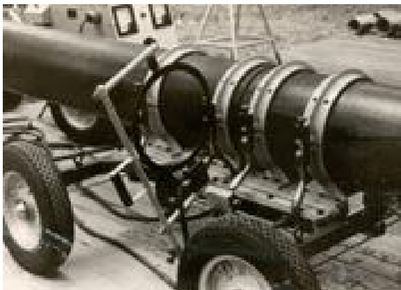
Рис. 3.7 - Пристрої для зварювання пластмасових труб а) установка для зварювання труб у стик; б) ручний апарат для зварювання труб у розтруб
